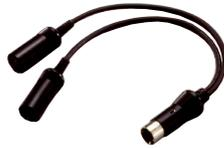
Verteilt die 13 ACC-Pins auf 7 und 8 Pole, um eine IC-PW1EURO anschließen zu können.
