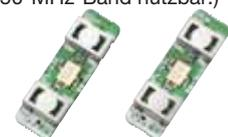
Schmalbandige Filter zur Reduzierung von Störungen durch Signale in der unmittelbaren Nähe des Nutzsignals.
