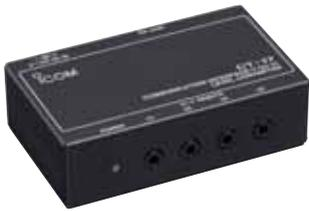
Zur Fernsteuerung des Transceivers mit einem PC über dessen RS232C-Schnittstelle. Frequenzen, Betriebsarten, Speicherkanäle usw. lassen sich steuern.
