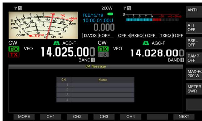
Wenn für [F1] bis [F7] die Tastenbelegung [MORE] (F1), [▲] (F2), [▼] (F3), [REPEAT] (F4), [(DELETE)] (F5), [NAME] (F6) angezeigt wird, drücken Sie [MORE] (F1), um zwischen der Tastenbelegung [MORE] (F1), [CH1] (F2), [CH2] (F3), [CH3] (F4), [CH4] (F5), [NEXT] (F7) und der Tastenbelegung [MORE] (F1), [CH5] (F2), [CH6] (F3), [CH7] (F4), [CH8] (F5), [NEXT] (F7) zu wechseln.
