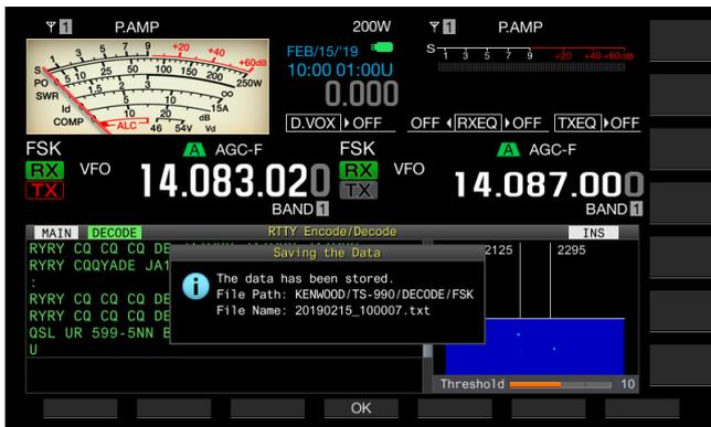
Falls **[SAVE]** (F4) nicht in der angezeigten Tastenbelegung zu sehen ist, drücken Sie **[MORE]** (F1). Es wird nun eine alternative Tastenbelegung angezeigt.
