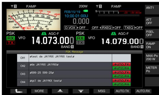
„AUTO RX“ wird rechts neben der PSK-Meldung angezeigt, und der Transceiver ist nun so eingestellt, dass er nach Senden der PSK-Meldung dieses Kanals automatisch auf Empfang schaltet. Wenn „AUTO RX“ nicht aktiviert ist, schaltet der Transceiver nach Senden der PSK-Meldung dieses Kanals nicht auf Empfang.
