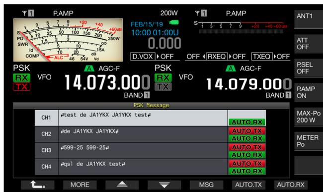
„AUTO TX“ wird rechts neben der RTTY-Meldung angezeigt, und der Transceiver ist nun so eingestellt, dass die RTTY-Meldung dieses Kanals automatisch gesendet wird. Wenn „AUTO TX“ deaktiviert wird, speichert der Transceiver die PSK-Meldung dieses Kanals vorübergehend im Zeichenfolgen-Puffer, und die Meldung wird nicht automatisch gesendet.
