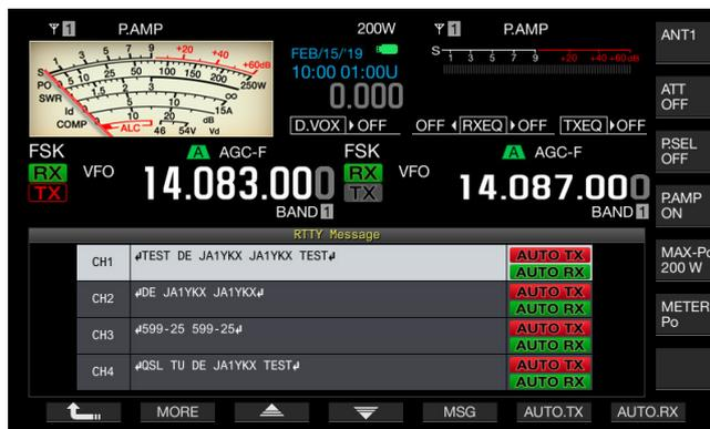
Falls **[MEMORY]** (F5) nicht in der angezeigten Tastenbelegung zu sehen ist, drücken Sie **[MORE]** (F1). Es wird nun eine alternative Tastenbelegung angezeigt.
